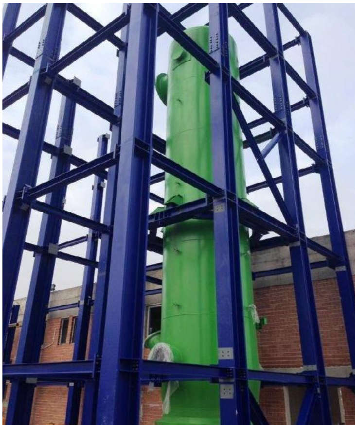
Vista detallada de Gasificador de lecho fluido burbujeante de 2310 Kg/h.
